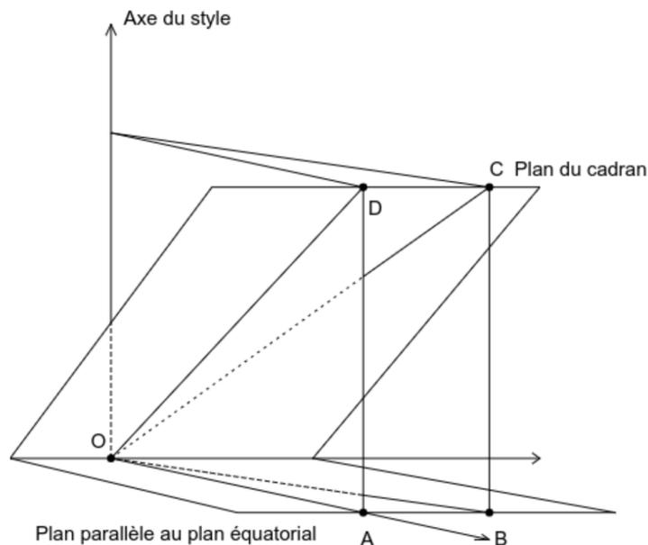
On reprend les notations de la figure précédente. Le plan  $OAD$  est le plan méridien de midi et le plan  $OBC$  est un autre plan méridien. Les droites  $(AD)$  et  $(BC)$  sont parallèles à l'axe du style et les droites  $(AB)$  et  $(DC)$  sont parallèles.
